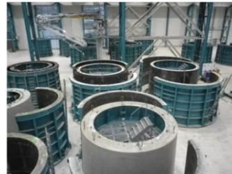
Figure 24 : Moules à sections
