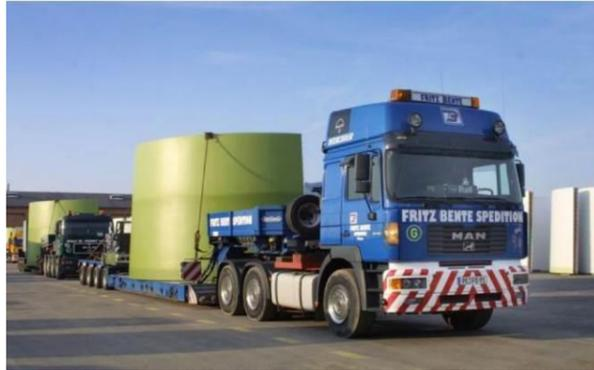
Photo 1 : Sections béton chargées sur camion de transport
