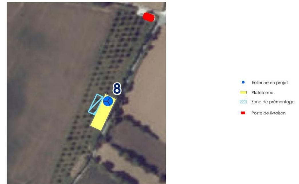
Figure 37 : Zoom sur l'organisation du chantier au pied d'une éolienne
