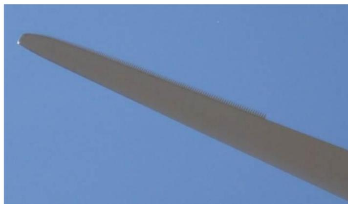
Figure 16 : Système de Serration sur une pale d'éolienne
