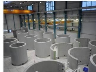
Figure 25 : Sections complètes avant transport
