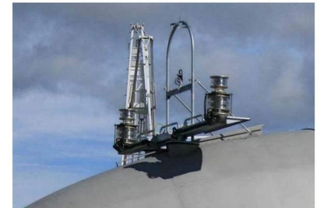
Figure 26 : Détail du balisage d'une nacelle
